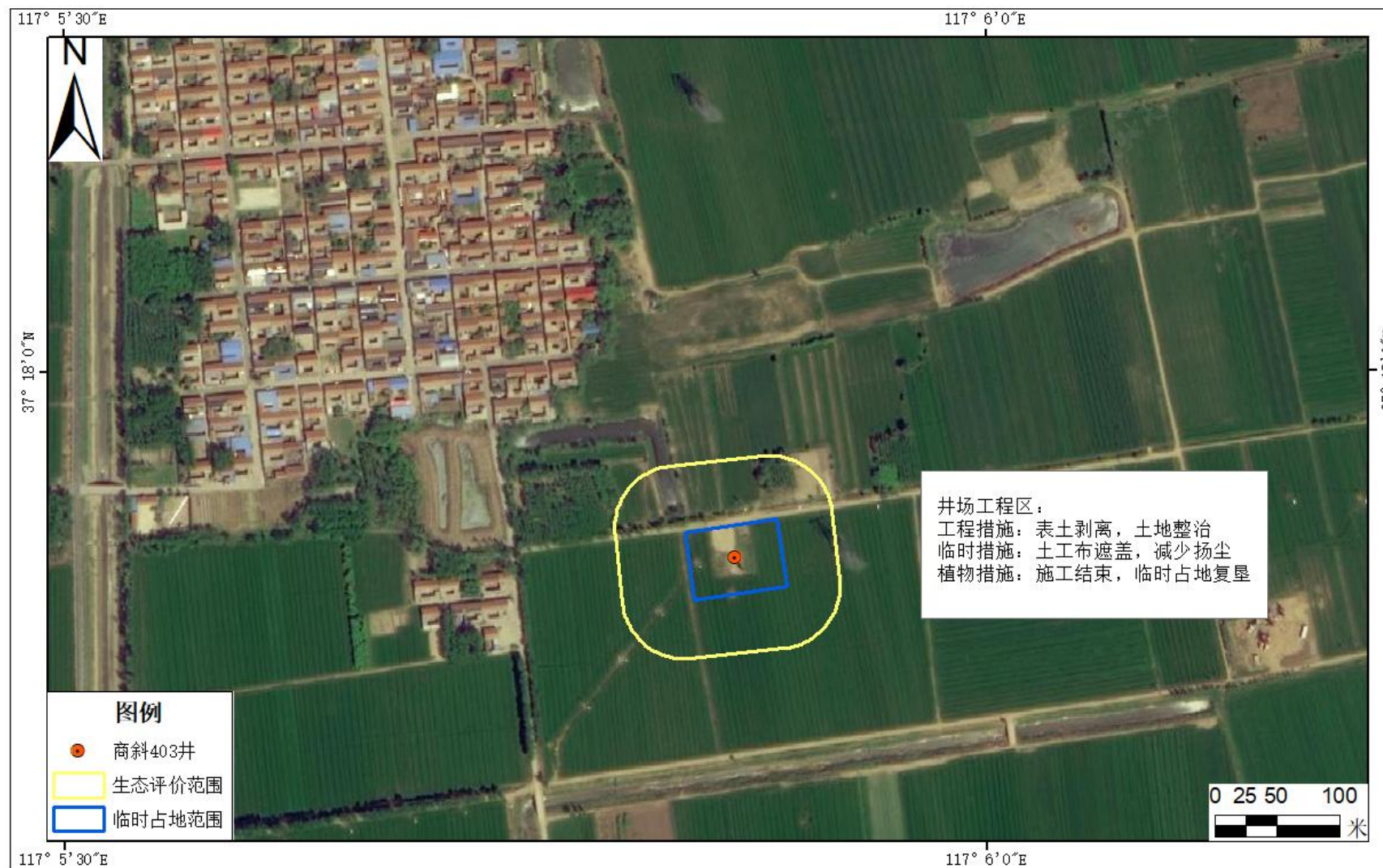
附图 6 生态环境保护措施平面布置示意图
