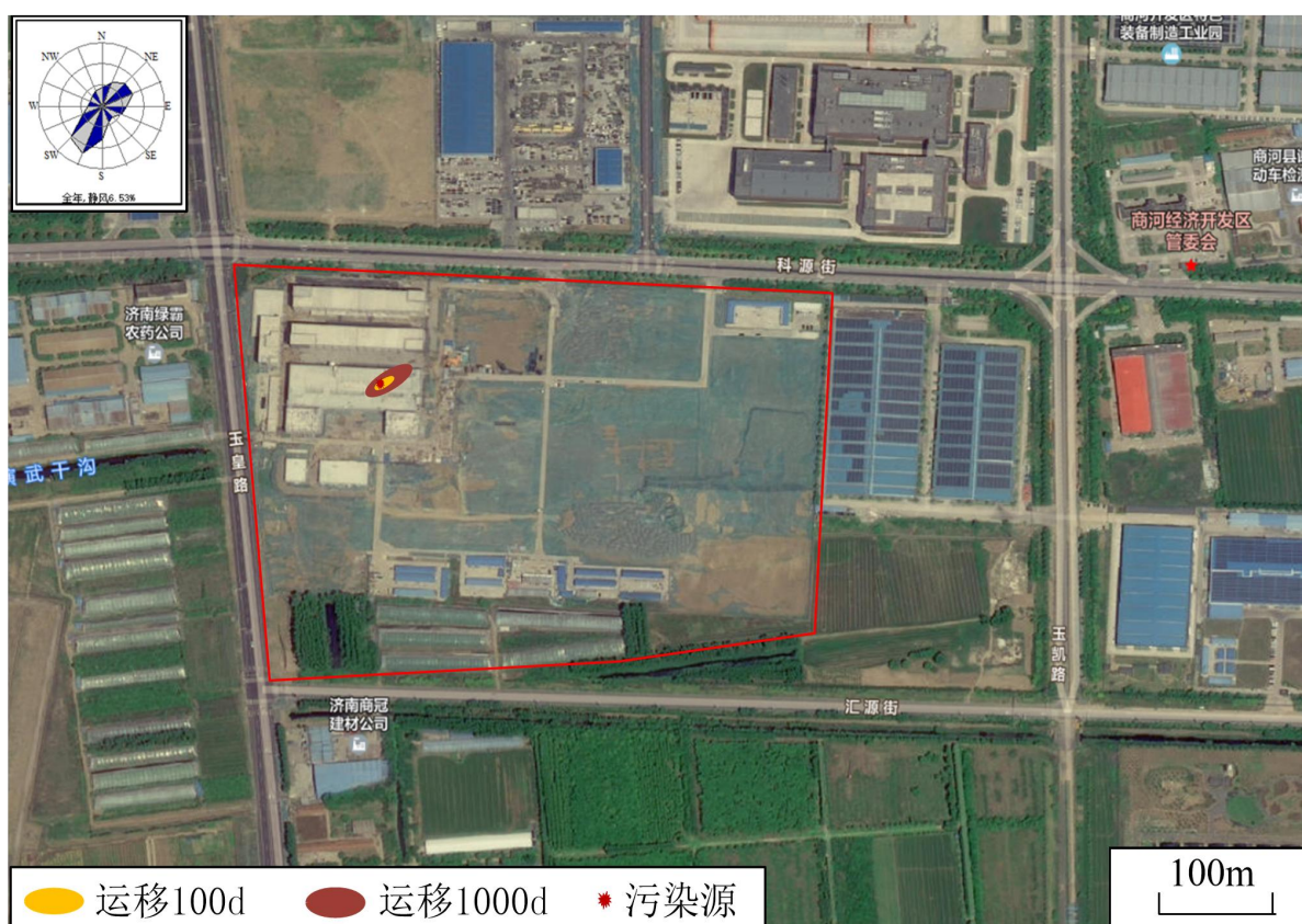
图 6.4-2 瞬时泄漏事故发生后六价格的超标范围示意图
